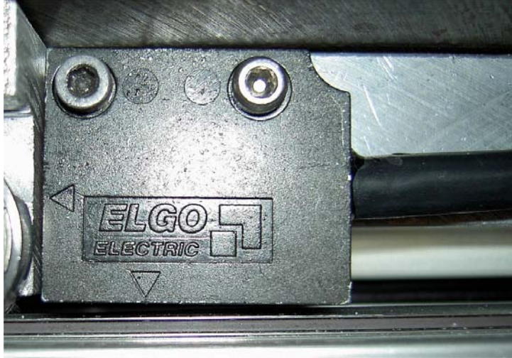
Figur 9: Magneto-resistiv givare ELGO LMIX2 monterad på skyttel och magnettejp påklustrad på cylinderprofilen, på den pneumatiska linjärenheten.
