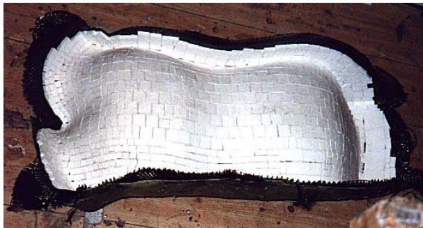
Stolen lamineras, mot ytterlaminatet har kärnmaterialet pusslats på
