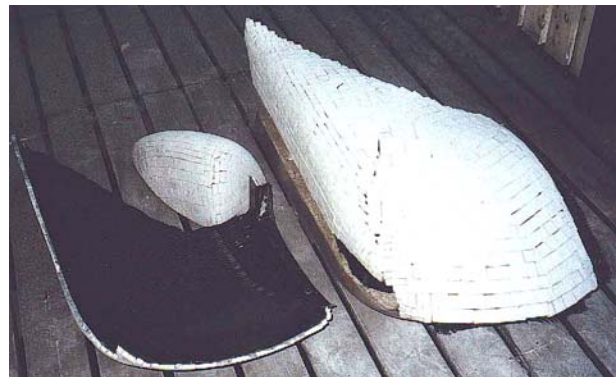
Delarna till bakkåpan med kärnmaterial påpuzzlat på innerlaminatet
