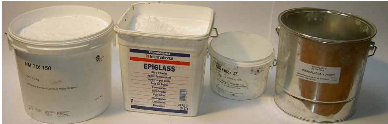
Fyllmedel för hårdplaster, främst epoxi. Från vänster till höger: mikrobällonger (brun), mikrobällonger (vit), limpulver (cellulosapulver), tixotroppulver (kiseloxid)
