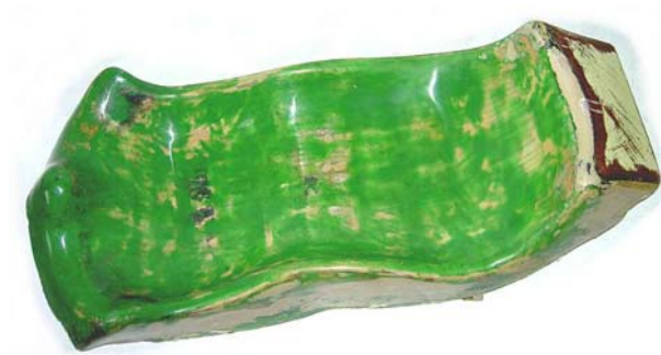
Slipad och polerad positiv stolsform
