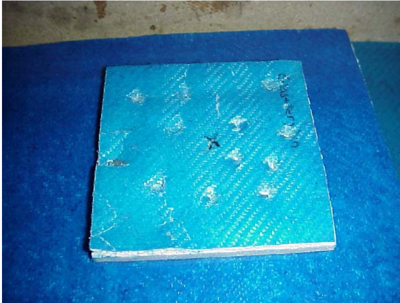
Infärgade glasfiberlaminat, det övre efter slagprov
