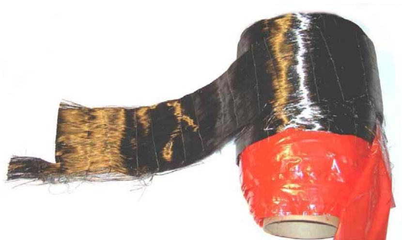
Enkelriktad kolfiberväv Toray T-600 med svetsad tvärbindingstråd
