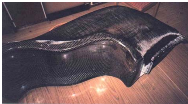
Kolfiberväv till ena sidan av bakkåpan tillpassas innan laminering
