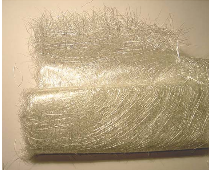
Emulsionsbunden korthuggen glasfibermatta 300gr/m 2 för armering av polyester
