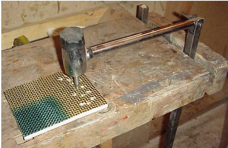
Enkel slagtestutrustning på laminat med tigmatta (delvis infärgad)
