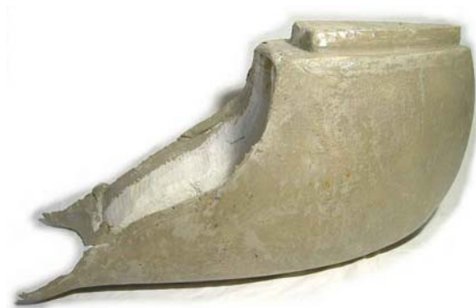
Positiv form till bakkåpan, spacklad med betongspackel och penslad med epoxy
