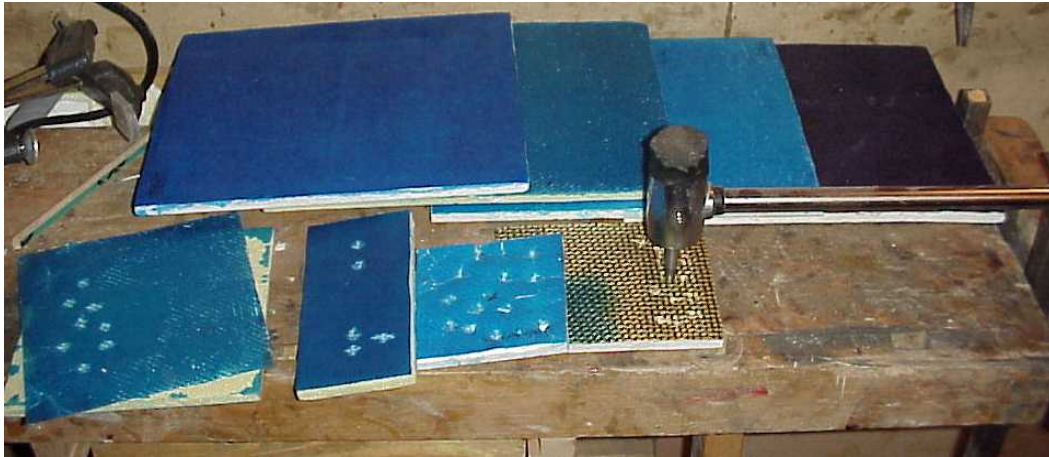
Slagtestutrustning och olika provlaminat för slagtest, tryck och utseende
